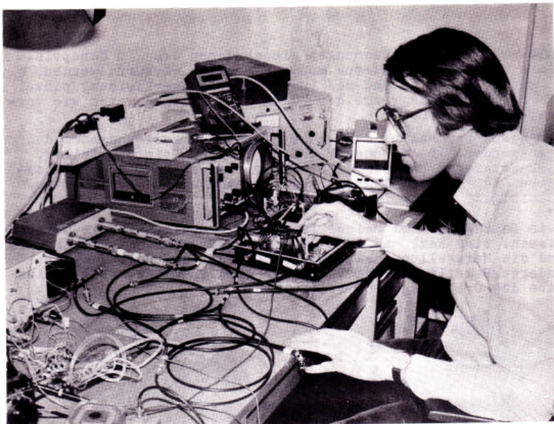
Ulrich Müller (DK4VW) beim Testen der Baugruppe HELAPS (High Efficiency Linear Amplification by Parametric Synthesis) für den zukünftigen AMSAT-Phase-3B-Satelliten. Fotos: AMSAT-DL/W.Gladisch
