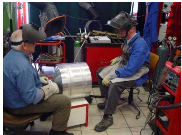
Bild 1: Der Tank von P3E wird zusammenschweißt.
