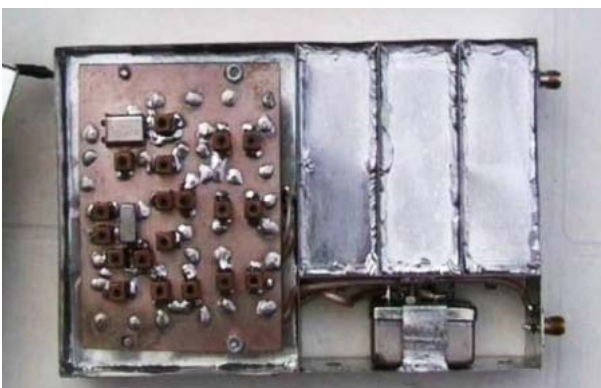
Bild 7: Der U/V-Transponder: links die Senderplatine, rechts oben das 70-cm-EingangsfILTER, unten rechts das 100 kHz breite ZF-FILTER. Unterhalb des Senders befindet sich die gleich große Empfängerplatine.
