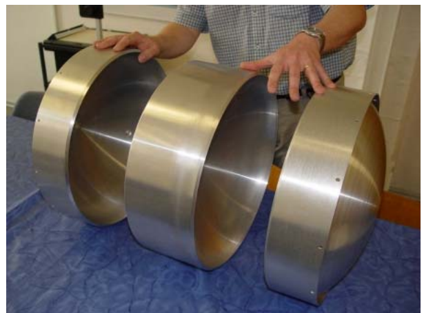
Bild 2: Drei Tankteile bilden zwei Kammern für den Treibstoff des Apogäumsmotors.
