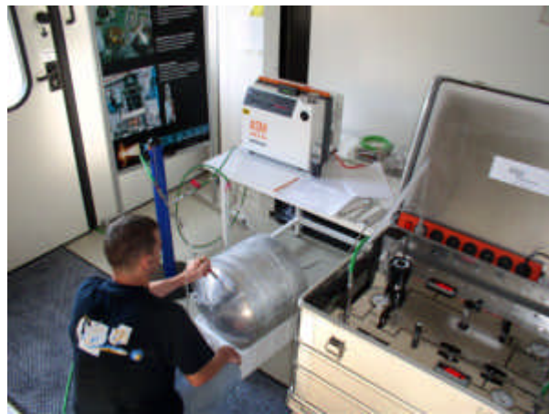
Bild 5: Der Treibstofftank wird vom Propulsion-Team bei EADS auf Dichtigkeit geprüft. Im Bild bereitet Thomas Maier die Messungen vor.
