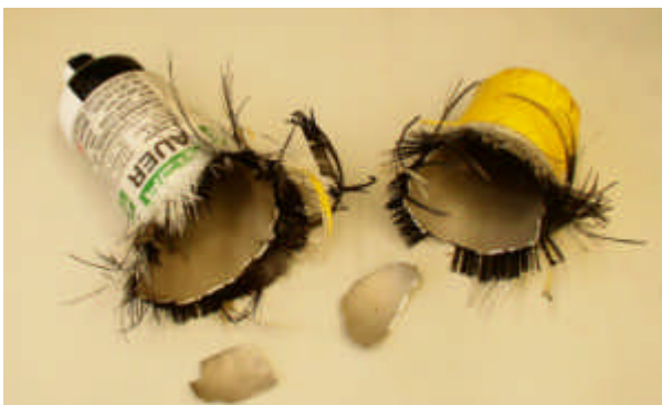
Bild 4: Bei 1160 bar ist die Heliumflasche geplatzt, 400 bar muss sie an Bord von P3E standhalten.
