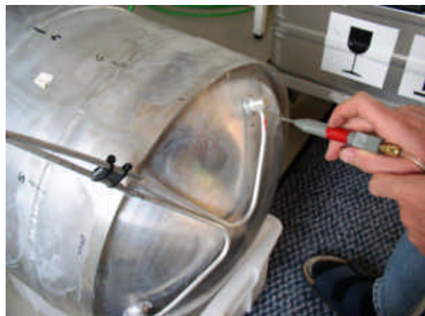
Bild 7: Der letzte Dichtigkeitsstest an den Tankstutzen
