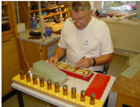
Bild 1: Horst Wagner baute die Batteriemodule zusammen. In Arbeit ist das Testmodul, davor aufgereiht die 13-AH-NiNM-Zellen der Hauptbatterie
